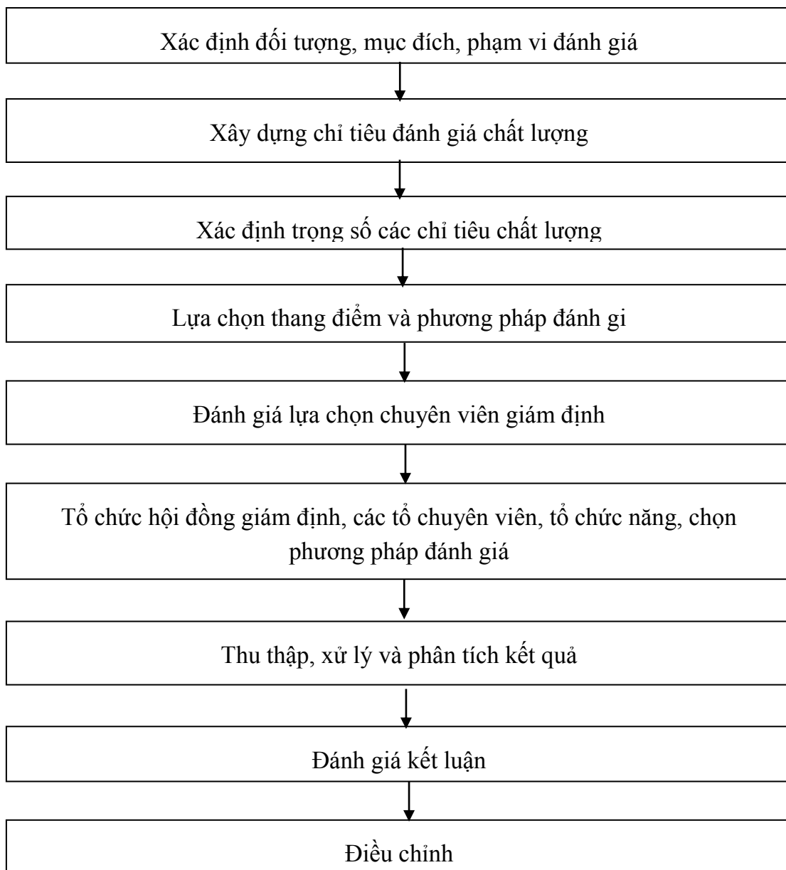
Hình 6.1. Trình tự tiến hành đánh giá chất lượng theo phương pháp chuyên gia
